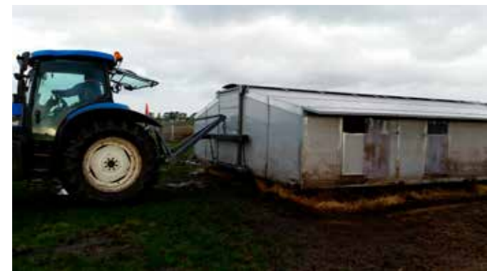
BILLEDE 10 | Hytten hæves i modsatte ende af hjulene og trækkes efter traktoren.
