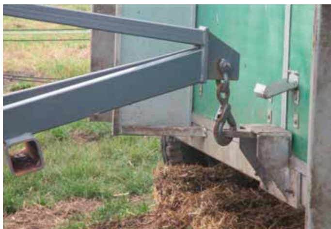
BILLEDE 20 | Her flyttes hytten med specialudstyret til so-hotellet. Her vil ikke opstå problemer med at komme ind under øjet. Lastekrog behøver minimal frigang for at fæstnes til hytten.
